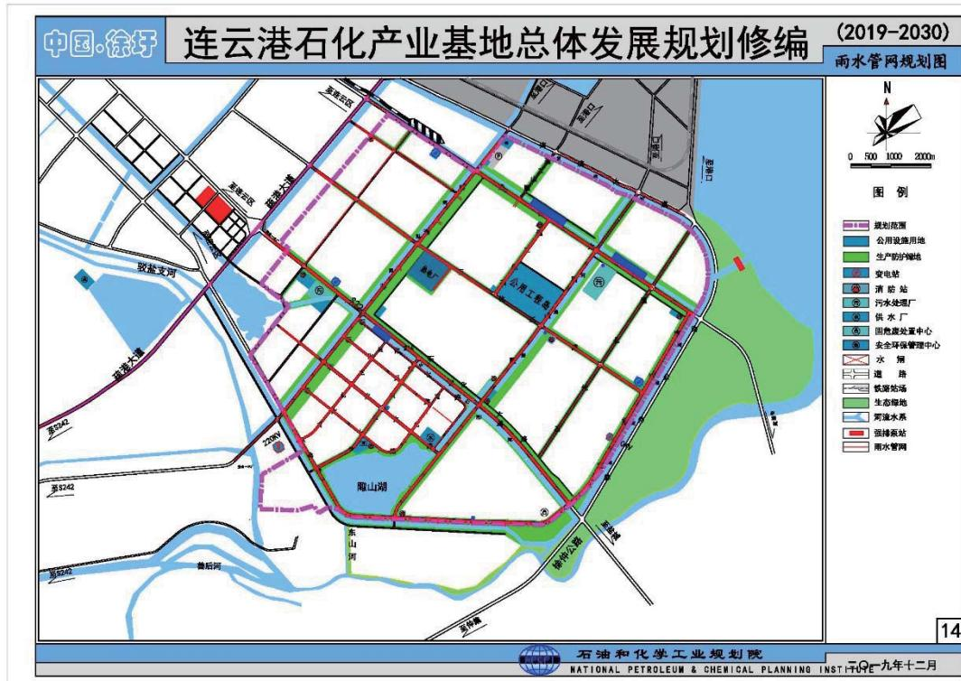
图6.2.6-3 石化基地雨水管网及雨水强排泵站分布示意图
