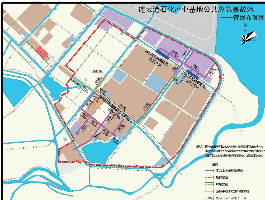
图 6.2.6-5 石化基地公共应急事故池管线布置图
